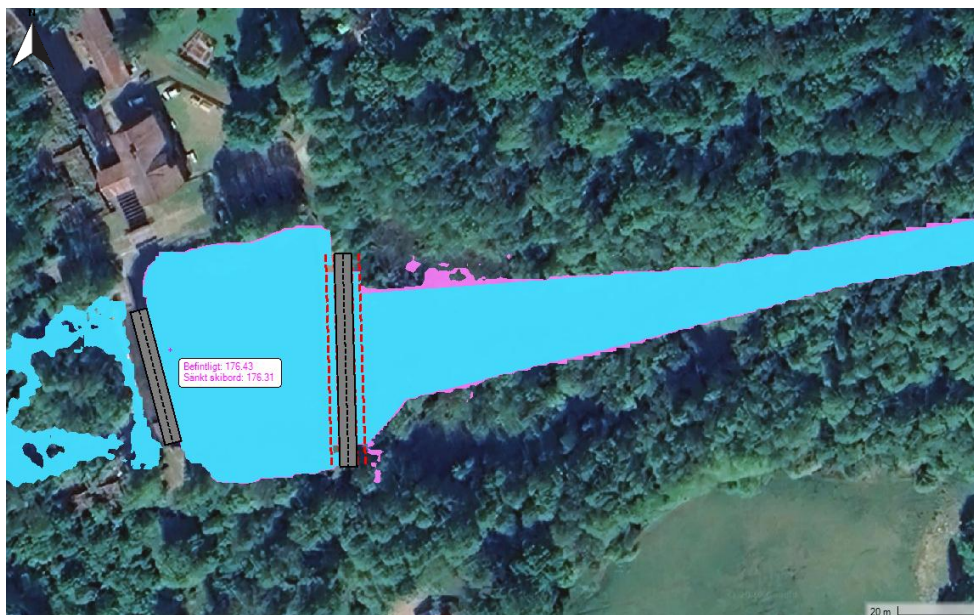
Figur 6. Vattenutbredning för lågt flöde (0,3 m 3 /s). Blå är vattenytan vid sänkt skibord och rosa är vid befintlig nivå på skibord.
