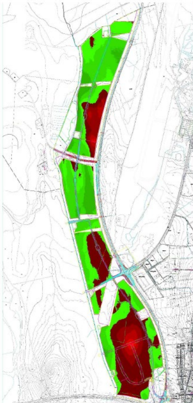
Figur 27. Schackt och fyllnadsplan. Grönt markerar fyllnad, och rött schackt.
