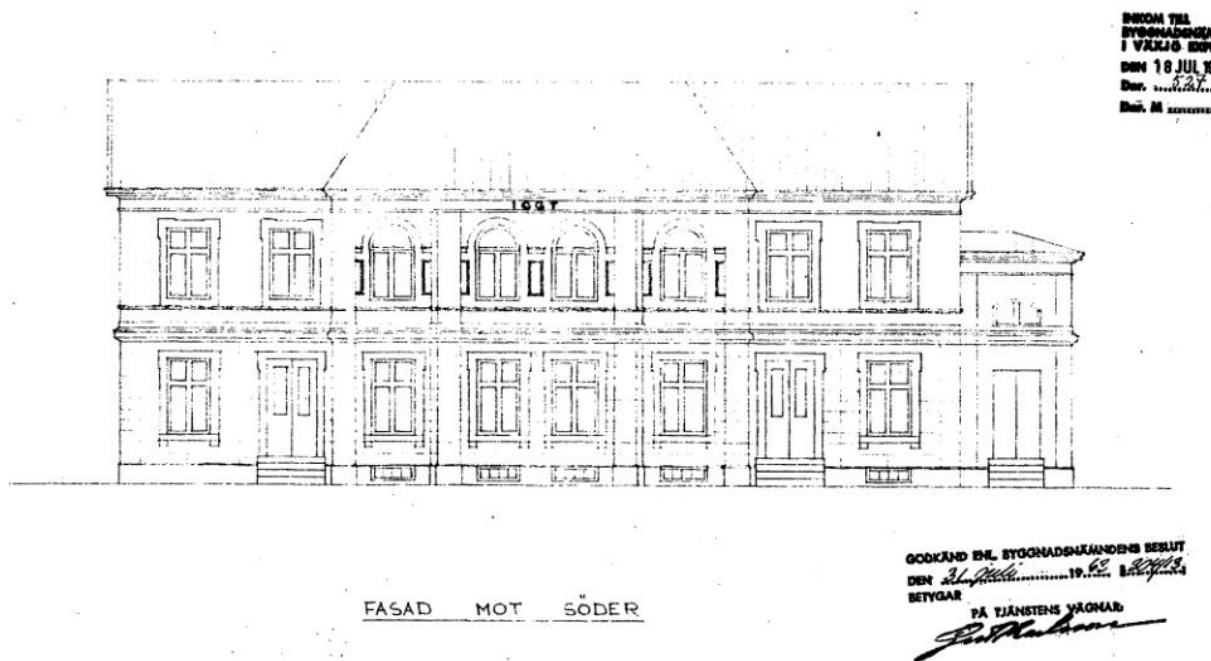
Figur 23 Bygglövshandling från juli 1963 som visar den stympade söderfasaden där den på taket överskjutande delen av mitttrisaliten tagits bort. Källa: Växjö kommun
