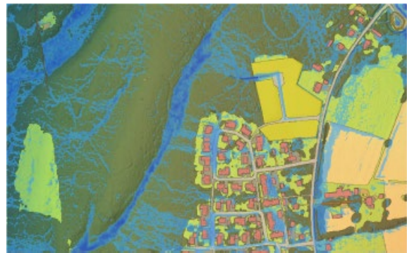
Illustration 25 och 26: Skyfallskartering vid befintliga förutsättningar till vänster och vid ändrad markanvändning till höger.
