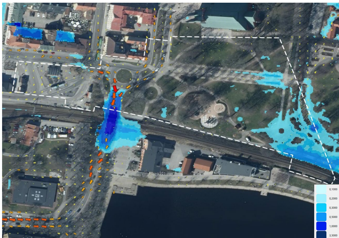
Figur 7: Översvämning vid 20-års regn. Nyanserna visar från 10cm till 1m+. Även pilar visas för flödesriktning. Större pil medför högre hastighet. Även legend visas nere till höger i bild. Planområdet redovisas med vit streckad linje.
